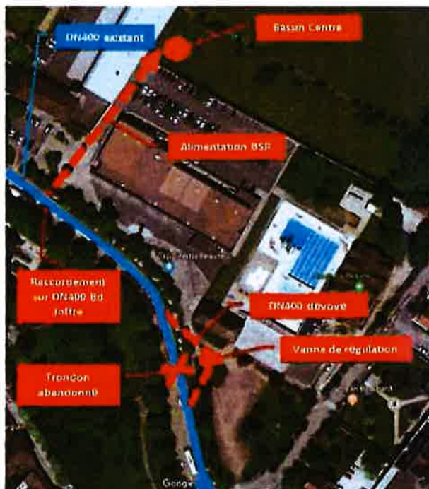
Figure 9 - Vanne de régulation pour l'alimentation du BSR Centre
